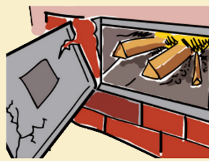
Reparar rajaduras y reemplazar partes defectuosas en la estufa
